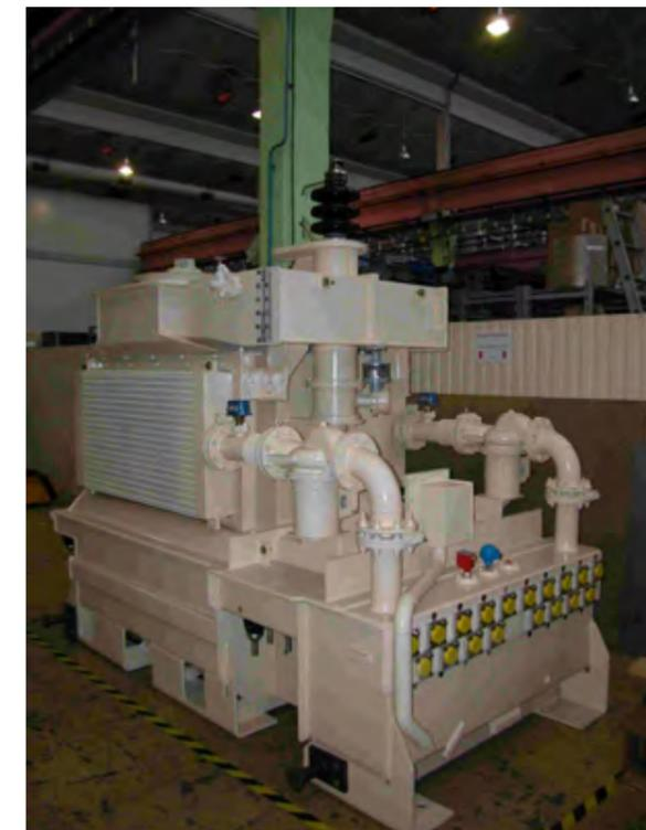
Figure 3: Transformateur principal de motrice TGV asynchrone
